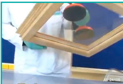
La adhesión inmediata permite mover las unidades tras la aplicación del sellante
