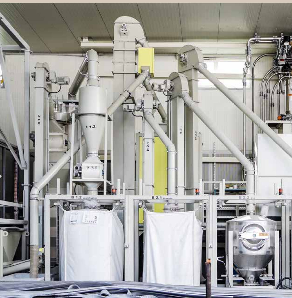
La moderna planta de reciclaje permite reutilizar internamente los descartes y recortes de los perfiles de PVC.
