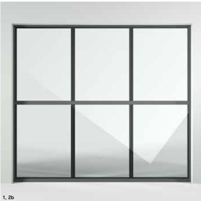
Frontal acristalado de seis campos con montantes revestidos de vidrio y marco oculto. No posible con el zócalo revestido de vidrio; el acristalamiento siempre debe quedar sujeto en dos lados.
