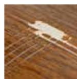
Las películas con acabado madera pegadas a los perfiles de PVC convencionales se desprenden fácilmente en caso de daño.
