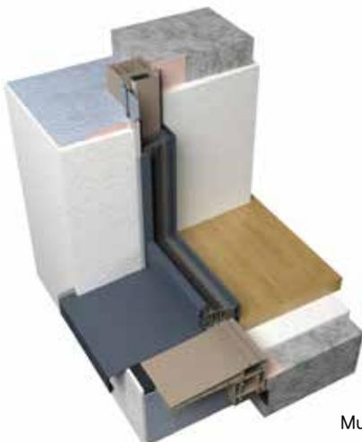
Muro con aislamiento térmico
