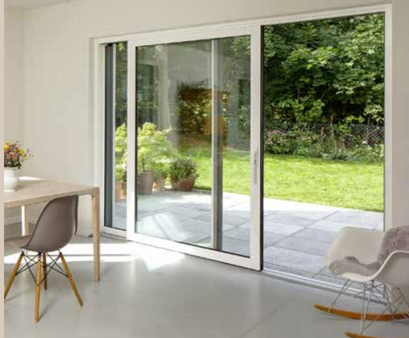
Además, las soluciones sin soleras no tienen puntos de cierre a lo largo de la solera. Por regla general tienen juntas magnéticas que, debido a la falta de puntos de presión, no tienen el mismo efecto estanco que una junta entre marco y hoja.
